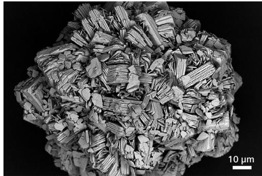
Lanthankarbonat, abgebildet bei 1 kV mit Inlens Duo BSE.  $\text{LaCO}_3$  ist ein Phosphatbinder, der als orales Therapeutikum bei Dialysepatienten eingesetzt wird.
