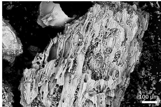
Gesteinsprobe, abgebildet mit dem YAG-BSD bei 20 kV.
