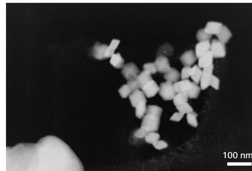
25–50 nm große Eisenoxidpartikel, abgebildet mit dem aSTEM-Detektor im Dunkelfeld-Modus bei 20 kV.
